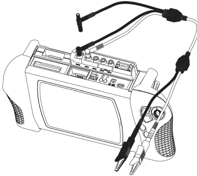
Afbeelding 2-1 Voorbeeld van een aangesloten gele kabel
