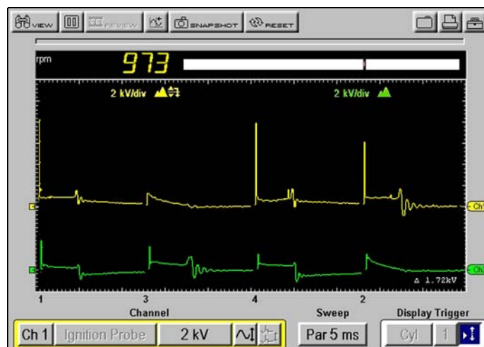
Afbeelding D-8 Voorbeeld van detectie van kortgesloten bougie
