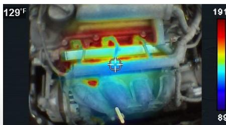
NOUVELLE fonction de fusion d'images facilitant l'identification et l'emplacement du composant affiché
