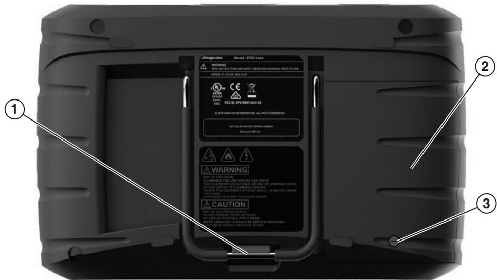
**1— Eingebauter Ständer** – Der eingebaute Ständer kann auf der Rückseite des Diagnosewerkzeugs ausgeklappt und zur Lagerung wieder eingeklappt werden.
