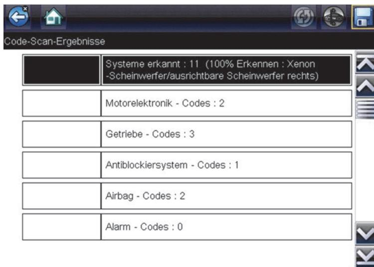
Abbildung 4-6 Code Scan – Gesamtergebnis der analysierten Systeme
